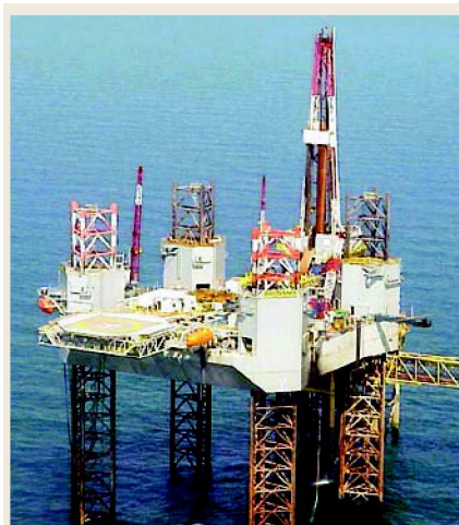
Рис. 1. Одна из 23 принадлежащих компании GlobalSantaFe консольных самоподъемных буровых установок с независимыми опорами GSF Britannia , на которых использовались озоноразрушающие хладоновые системы пожаротушения
